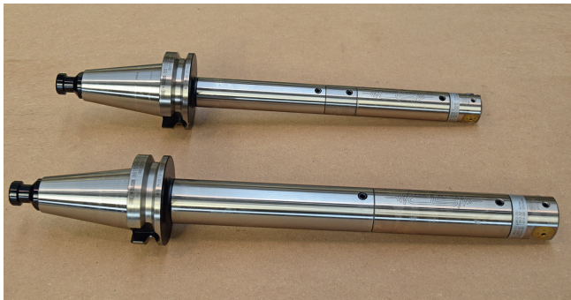
3 In Kombination mit dem BIG-Plus-Spindelsystem, das gleichzeitig einen doppelten Kegel-Flansch-Kontakt zwischen Spindel und Maschine gewährleistet, reduziert der Smart Damper das Problem von Vibrationsspuren an der Oberfläche erheblich © BIG Kaiser
