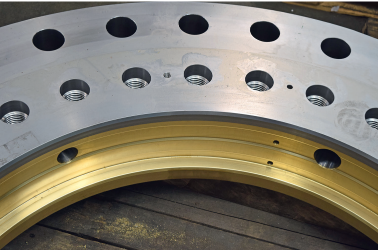
2 In solch einen Flansch aus S355J2G3 mit Al-Bz 8-Beschichtung für Wasserkraftwerke sind unter anderem vier radiale, 400 mm tiefe 58-mm-Bohrungen h_6 mit einer Rauheit von 0,8 \mu\text{m} einzubringen. Mit SmartDamper-Stangen ist es möglich © BIG Daishowa
